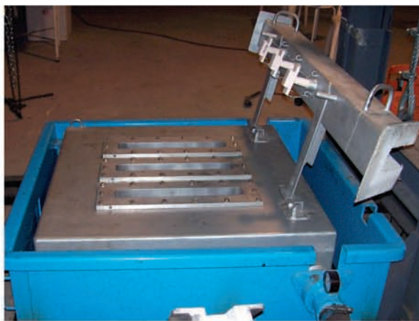
EQUIPO DE 3 LINGOTERAS PARA PRODUCCIÓN DE PLACAS SECCION 500X55X 4.000 MM.
