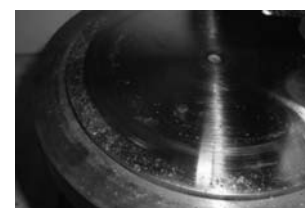
Huella (trac) de muestra aM a 2 kgf/cm 2 de carga
