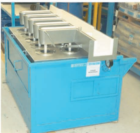
EQUIPO DE 10 LINGOTERAS PARA PRODUCCIÓN DE BARROTES, ADMITE DIAMETROS DESDE 100 HASTA 152 MM.X 4.000 MM. DE LONGITUD.
