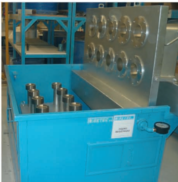
EQUIPO DE 10 LINGOTERAS PARA PRODUCCIÓN DE BARROTES, ADMITE DIAMETROS DESDE 100 HASTA 152 MM.X 4.000 MM. DE LONGITUD.
