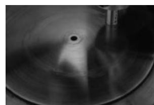
Huella (track) de muestra a0 (sin adición de plomo) a 1.5 kgf/cm 2 de carga.
