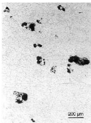
Figura 19. Aglomeración de pieles de óxido con burbujas de gas.
