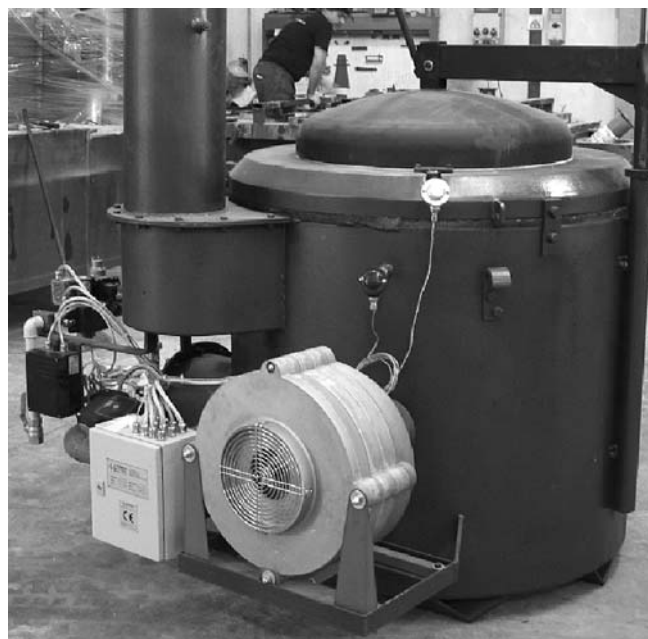
Figura 27. Horno de crisol a combustible (HORC).
