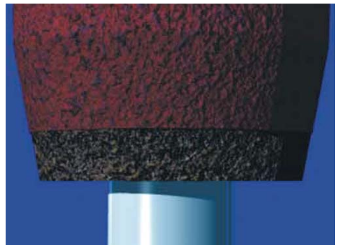
Figura 1. Manguito colocado sobre un resalte de pieza de superficie menor que la propia galleta.
