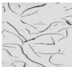
c. Probeta SCH2 – C Sin ataque. Grafito laminar tipo A. Tamaño 3,4. 100X.
