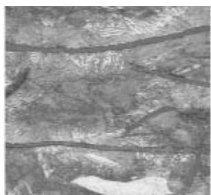
g. Probeta MB1 – B Ataque Picral. Matriz perlítica. 500X.
