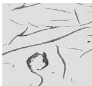
a. Probeta SCH1 – B Sin ataque. Grafito laminar tipo A. Tamaño 2,3. 100X.
