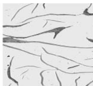
b. Probeta MB1 – B Sin ataque. Grafito laminar tipo A. Tamaño 3,4. 100X.
