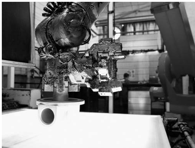
Un robot deposita un filtro lubricado sobre una rampa.
